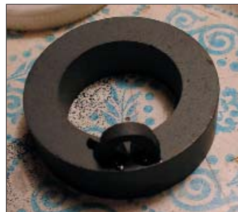
Рис. 10. Сердечник электромагнитной «нашлепки», приклеенный к основному сердечнику
