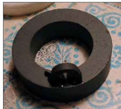
Рис. 10. Сердечник электромагнитной «нашлепки», приклеенный к основному сердечнику
